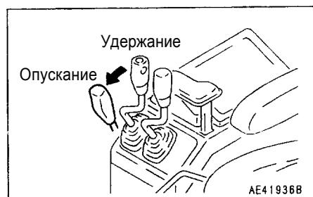
5. Заблокируйте рычаг управления стрелой ⑤ и рычаг управления ковшом ⑥ при помощи рычага блокировки ⑦.
